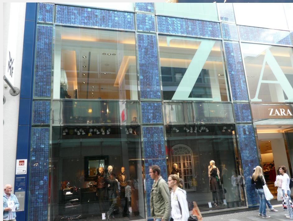
德国科隆步行街一家商店的光伏幕墙，12 kW，中空玻璃结构
